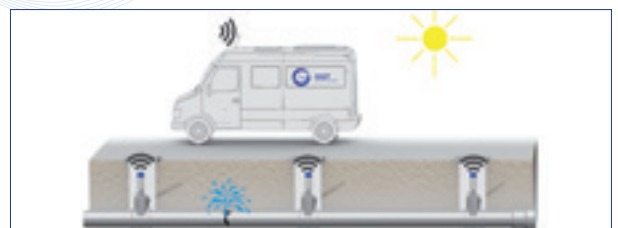
Récupération des informations de bruit par communication radio (mode patrouille) ou GSM (via le Waternet) Corrélation multi-points entre logger avec post-traitement
