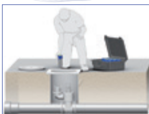
Installation des loggers sur le réseau par les bouches à clé
