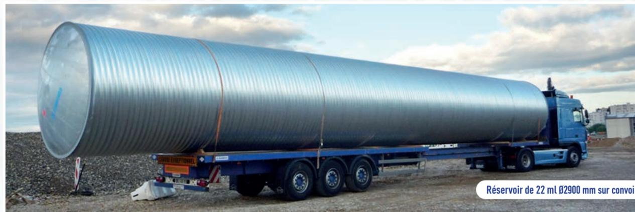
Réservoir de 22 ml Ø2900 mm sur convoi
