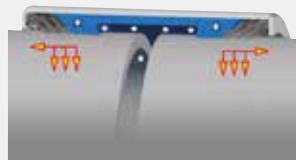
Fixation axiale avec 3 bagues de crampage
