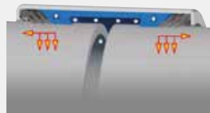
Fixation axiale avec une bague - Série légère
